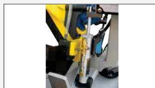
Cilindro idraulico per regolare la velocità di discesa dell'arco durante l'uso in modalità gravitazionale.
