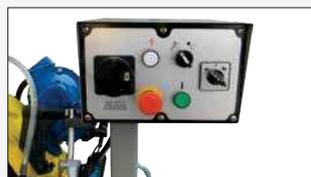
Quadro elettrico con comandi ausiliari a 24V AC protetto contro le correnti magnetiche e termiche.
