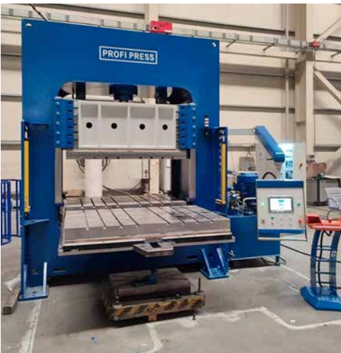
Custom-made Portal Press (160 Tn) with collection tray for axis Kundenspezifische Portalpresse (160 Tn) mit Auffangwanne für Achse Presse à portique sur mesure (160 Tn) avec plateau de récupération pour l'axe Prensa de pórtico a medida (160 Tn) con bandeja de recuperación para el eje
